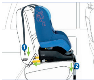
FIGURE 4 : Système d'attache DRE avec les deux types de 3ème point d'ancrage (© Bébé Confort)
