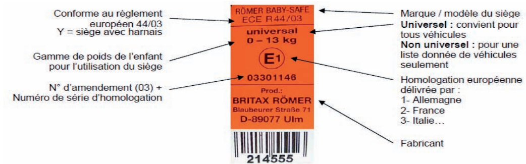
FIGURE 2 : Etiquette standardisée reprenant les éléments d'homologation d'un DRE
