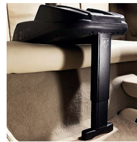
FIGURE 4 : Système d'attache DRE avec les deux types de 3ème point d'ancrage (© Bébé Confort)
